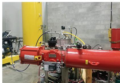
*Configurazione di prova dove la valvola a farfalla ad alte prestazioni McCannalok S42 e l'attuatore pneumatico con sistema scotch and yoke S98 hanno superato 1 milione di cicli con zero perdite.*
